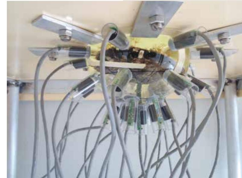
Le magnétomètre construit par les chercheurs de l'IFREMER pour mesurer la rotation des perles. L'huître greffée par un nucléus magnétique est positionnée dans le dome au centre (cliché C. Soyez/IFREMER).
